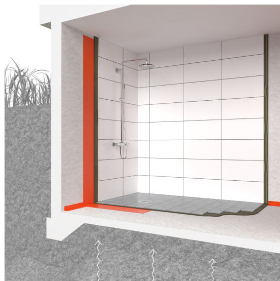
Källare med tillskjutande markfukt.
