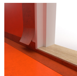
Tröskel i nivå med vägg.
